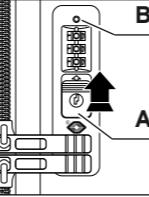
1. Réglez la combinaison sur la valeur par défaut. Par sécurité, vérifiez que vous pouvez pousser le contact à ouverture **A** vers le haut. Lors du réglage, les tirettes de la fermeture à glissière ne doivent pas se trouver dans le cadenas.
